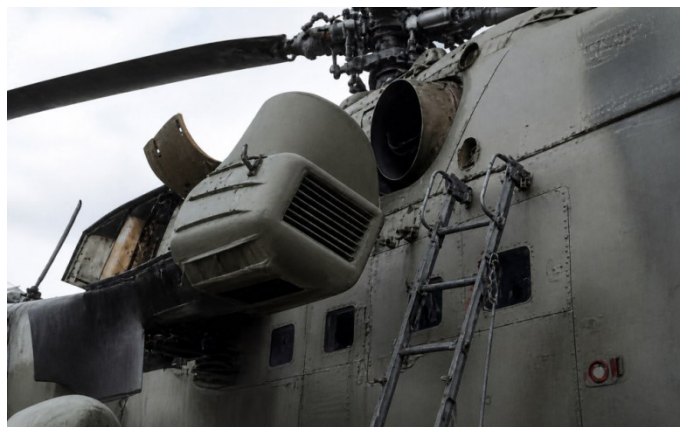
Слика 40. Издувни штит у склопљеном положају
